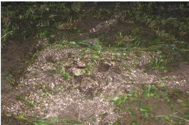
Abb. 10: Wasseraufstoss im Vorland des Hintergrabens während dem Hochwasser 2005 (ohne Materialaustrag): Anzeichen eines hydraulischen Grundbruchs.
