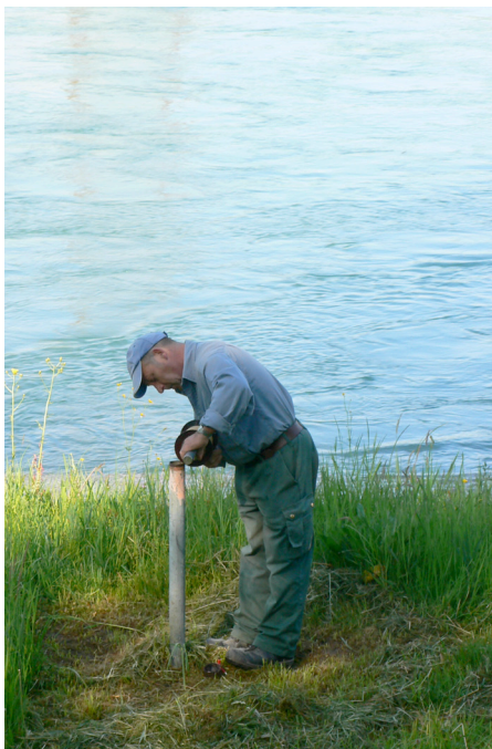
Bild 5: Messung der Grundwasserspiegel
