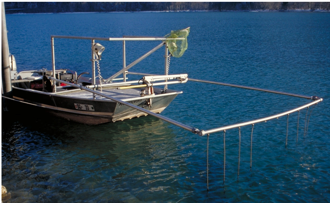
Abb. 2.1: Elektrofischfangboot des Amts für Jagd & Fischerei St. Gallen. Im Vordergrund rechts die aus 8 Stahlkabeln bestehende Anode.
